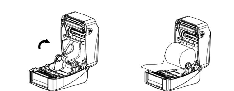
01/双手按压上盖左右两侧开关,开启打印机上盖。
