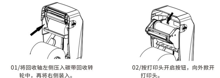
01/将回收轴左侧压入碳带回收转轮中,再将右侧装入。
