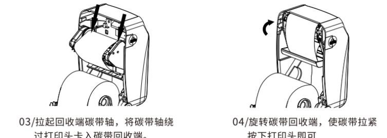
03/拉起回收端碳带轴,将碳带轴绕过打印头卡入碳带回收端。
