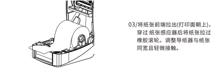
03/将纸张前端拉出(打印面朝上),穿过纸张感应器后将纸张拉过橡胶滚轮。调整导纸器与纸张同宽且轻微接触。
